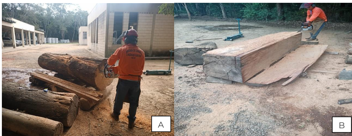
Figura 16. Reaproveitamento de madeira A) B) Ação de desdobras de madeira para confecção de mesas e bancos.
